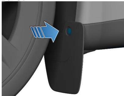
8. 在车辆右侧再次执行此步骤，以安装右侧挡泥板。
