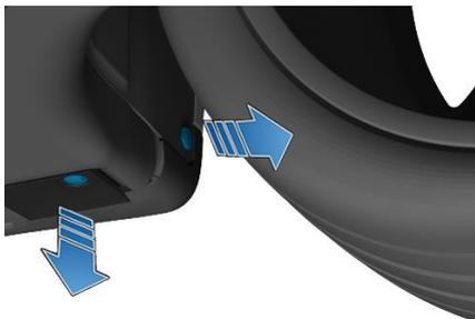
5. 将挡泥板移入位，使背面的塑料锁片固定在轮拱内衬的下方，对齐挡泥板，从而使推拉式夹孔对齐。
