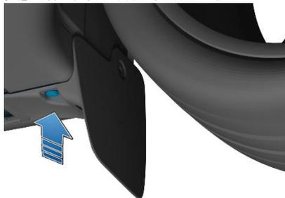
7. 将已打开（塑料铆钉已拔出）的新推拉式夹安装到轮拱内衬孔中，然后向内推塑料铆钉，以关闭推拉式夹。
