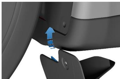
6. 将已打开（塑料铆钉已拔出）的新推拉式夹安装到下方槛板的孔中，然后向内推塑料铆钉，以关闭推拉式夹。
