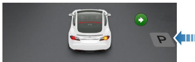
**注：**只有车辆的位置和/或周围环境允许自动泊车确定适宜的行驶路线时，泊车图标才会出现。如果自动泊车无法确定适宜的路线（例如，当行驶在狭窄街道上时，驶入停车位会导致车辆前部进入相邻车道），您可以重新定位车辆、寻找其他停车位或手动泊车。
