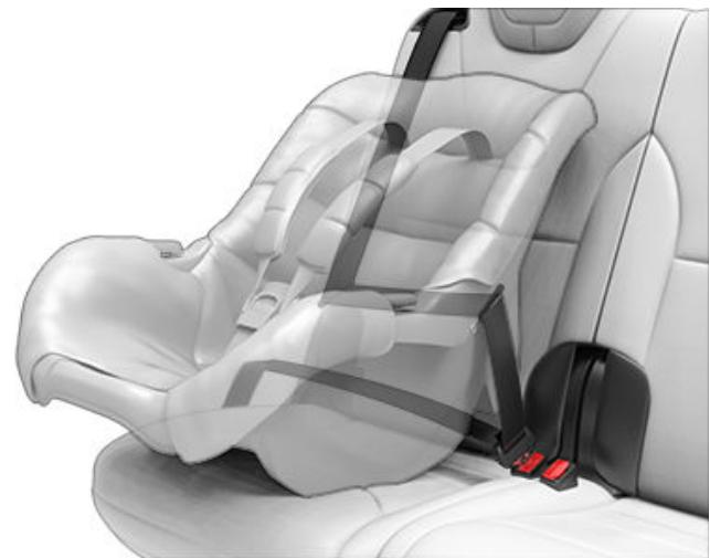
2. 让座椅安全带缩回，在将儿童安全座椅牢牢推入 Model S 座椅的同时，收紧松弛的座椅安全带。
