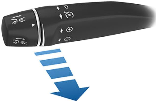
**注：**如果 Autopilot 自动辅助驾驶激活设置为下拉一次（点击[控制 > Autopilot 自动辅助驾驶 > Autopilot 自动辅助驾驶激活](#)），则朝自己拨动 Autopilot 自动辅助驾驶控制杆一次可启用自动辅助转向。如果设置为双拨动，必须快速连续朝向自己拨动 Autopilot 自动辅助驾驶控制杆两次才能启用自动辅助转向。
