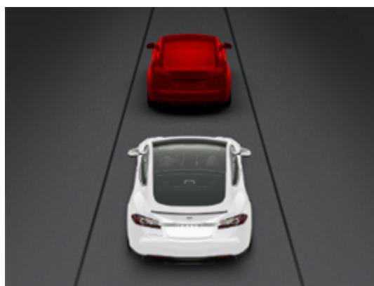
在碰撞风险降低后，图像和声音预警自动取消（例如，Model S 已减速或已停车，或车辆前方物体已离开车辆所在车道）。
