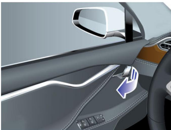
**注：**为防止儿童使用内部车门把手打开后车门，请在触摸屏上点击控制 > 车辆 > 儿童保护锁，打开儿童保护锁（请参阅[儿童保护锁 页码 21](#)）。
