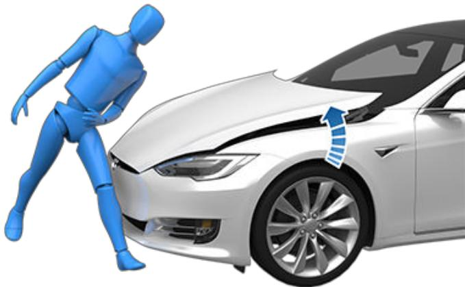
主动防护前罩弹开后，仪表板会显示一则警报，并伴随蜂鸣。立即驾驶 Model S 到最近的 Tesla 服务中心或 Tesla 授权的钣喷中心。弹出主动防护前罩后，请务必检修与主动防护前罩相关的传感器和执行机构。
