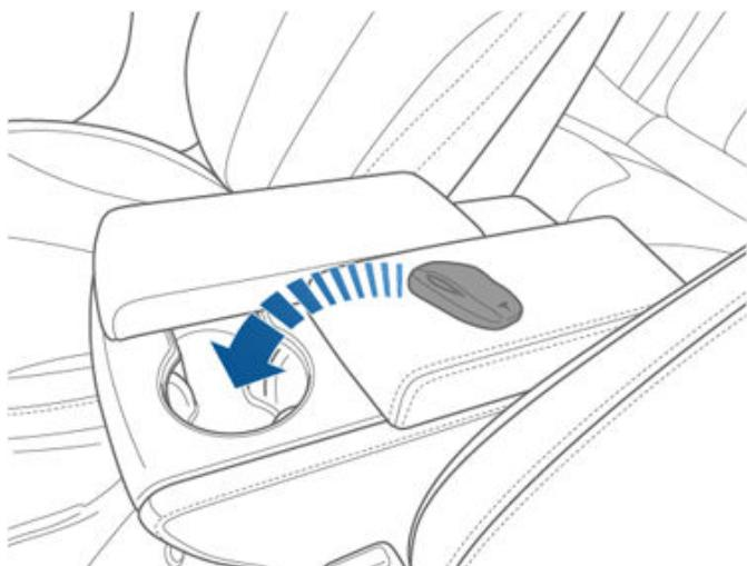
如果 Model S 仍未探测到遥控钥匙，请将遥控钥匙靠住中控台低压电源插座正下方（请参阅[低压电源插座 页码 9](#)）。或者使用另一把遥控钥匙试试。如果另一把遥控钥匙仍然无效，请联系 Tesla。
