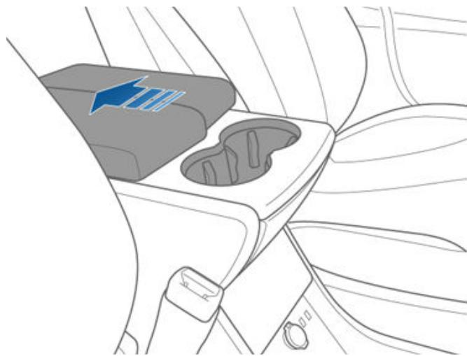
要露出后杯托（如果配备），可按下并释放中控台背面的杯托面板。
