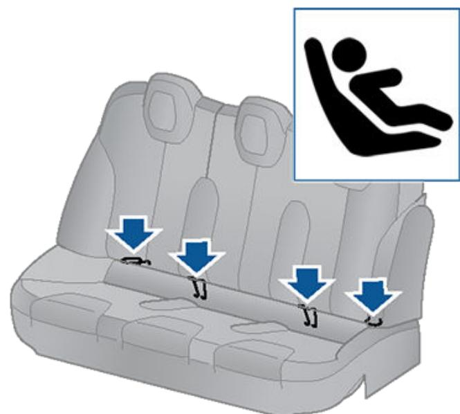
仅将 LATCH 儿童安全座椅安装到后排侧座位置。仅在座椅中间位置使用安全带固定座椅。
