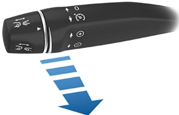
**注：**如果 Autopilot 自动辅助驾驶激活设置为下拉一次，则朝自己拨动一次 Autopilot 自动辅助驾驶控制杆可激活自动辅助转向（请参阅[自动辅助转向](#)页码 84）。点击[控制 > Autopilot 自动辅助驾驶 > Autopilot 自动辅助驾驶激活](#)并选择下拉两次，可在朝自己拨动自动辅助转向控制杆时仅启用主动巡航控制，而不启用自动辅助转向。
