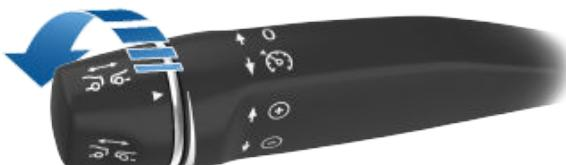
转动 Autopilot 自动辅助驾驶控制杆时，仪表板显示当前设置。显示所需设置时，可松开控制杆。
