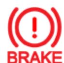
(加拿大) 除了在首次启动 Model S 时短暂显示外，如果仪表板在其他任何时间显示该红色制动指示灯，说明检测到制动系统故障或制动液液位低。请立即联系 Tesla。在确保安全的前提下，稳妥踩住制动器，以便停稳车辆。
