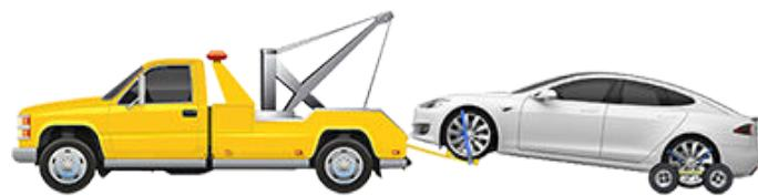
**警告：**启用运输模式（请参阅[激活运输模式 页码 175](#)），然后通过绞盘方式将 Model S 移至平板拖车上（请参阅[牵引至平板拖车上 - 有牵引环 页码 176](#)）。如果无法使用运输模式，或者无法使用触摸屏，那么必须使用自装式高速辅助轮或轮胎滑架承载车辆，将其移至批准的运输位置。Tesla 对因 Model S 运输或期间导致的任何损坏，包括因使用自装式高速辅助轮或轮胎滑架而导致的个人财产损失，不承担责任。
