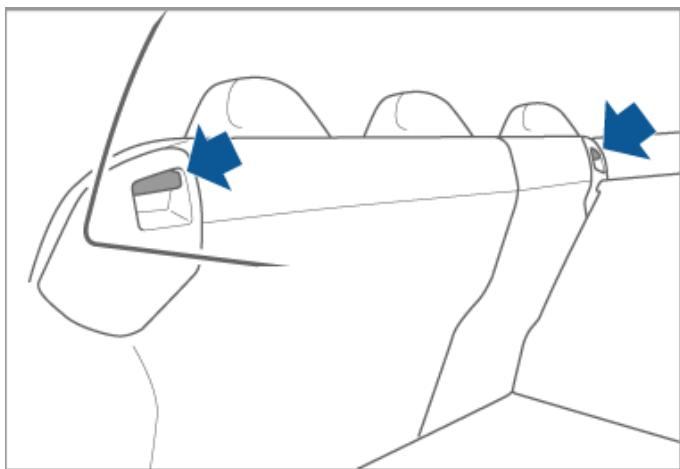
要折起后排座椅，拉动相应的控制杆并把座椅向前折起。
