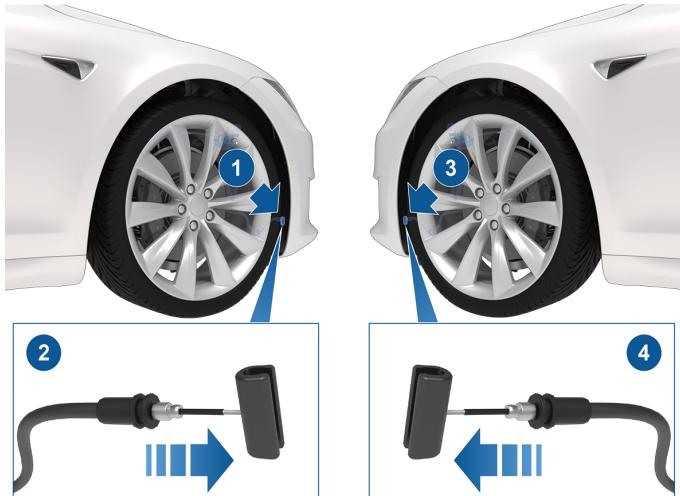
**注：**注意：一定要按顺序拉动固定带，否则将无法释放相应门闩，最终导致无法打开前备箱。
