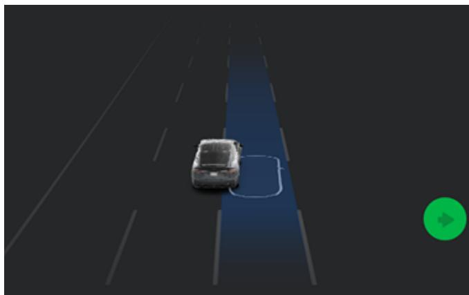
如果**要求变道确认**设为**关**，自动辅助导航驾驶将启用相关转向信号灯，检查是否有车辆和物体，并适时操控 Model S 驶入相邻车道。
