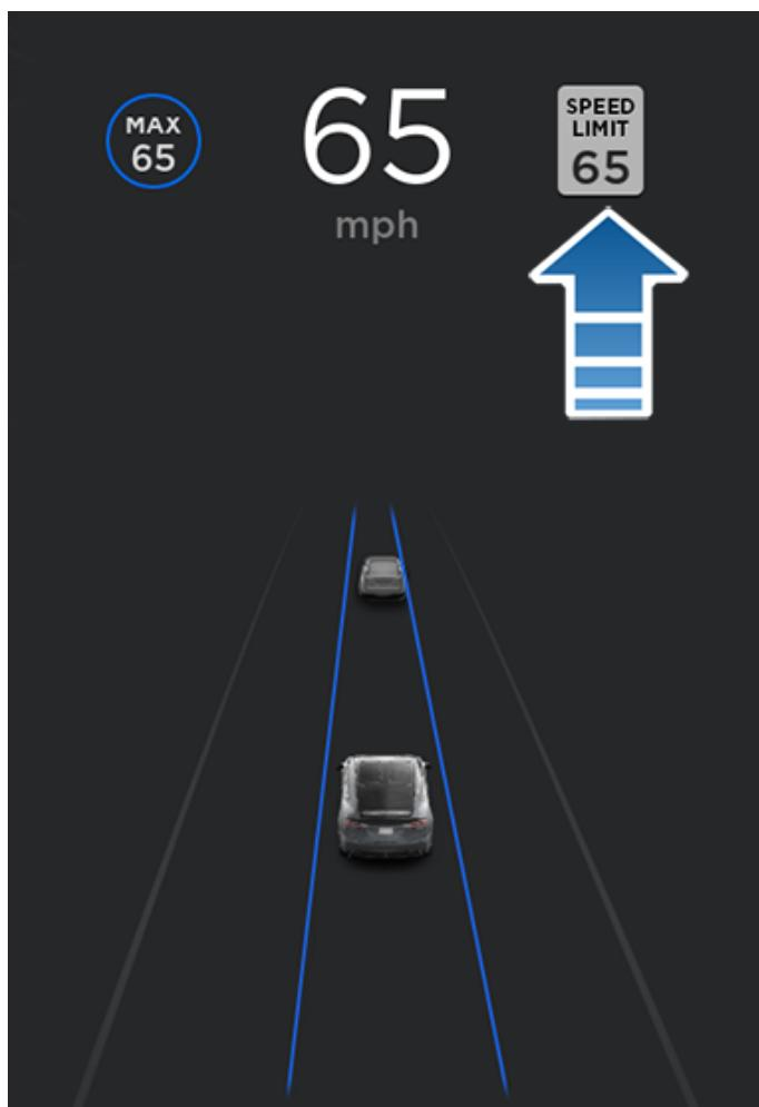
如果 Model S 无法确定限速，或者车速辅助不确定获取的限速是否准确，仪表板可能就不会显示限速标志，也不会启动报警功能。
