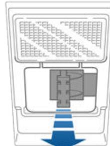
1. 用力向内拉下缘，拆下盖板。
