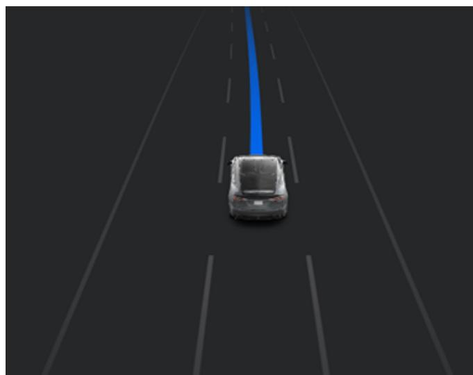
激活自动辅助导航驾驶后，当靠近导航路线中的一处匝道出口或交叉口时，相应的转向信号灯会亮起，自动辅助转向功能会将 Model S 驶入匝道出口或交叉口。
