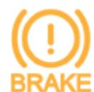
(加拿大) 如果检测到制动助力器故障，仪表板上将显示这一琥珀色驻车指示灯。在确保安全的前提下，稳妥踩住制动器，以便停稳车辆。液压助力补偿将处于激活状态（请参阅[液压助力补偿 页码 62](#)）。
