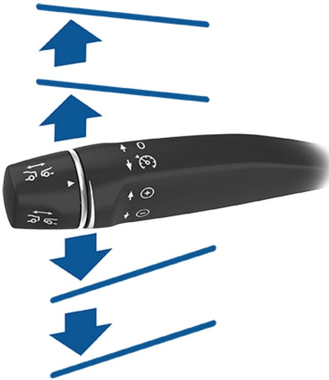
要以 1 mph (1 km/h) 为单位加速/减速，可向上或向下拨动控制杆到第一挡位后松开。要以 5 mph (5 km/h) 为增量逐渐增加/减小速度，可向上或向下拨动控制杆到第二挡位后松开。例如，以 57 mph 的速度行驶时，向上拨动控制杆到第二挡位后松开，可加速到 60 mph。仪表板上的图标显示所需的巡航速度时，您还可以通过将控制杆向上/向下拨到头而后松开来加速/减速。
