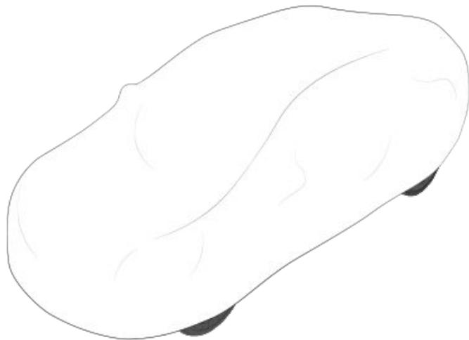
**⚠ 警告：**Model S 接通电源时，只能使用 Tesla 认可的车罩。使用非 Tesla 车罩会导致电池在充电过程中无法充分散热。
