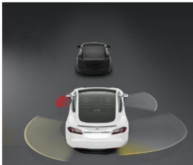
**警告：**每次驾驶前和使用 Autopilot 自动辅助驾驶功能之前，确保所有摄像头清洁，无障碍物阻挡（请参阅[清洁摄像头 页码 154](#)）。摄像头和传感器（如果配备）脏污，以及下雨和车道线褪色等环境条件可能会影响 Autopilot 自动辅助驾驶的性能。如果摄像头被遮挡或遮蔽，Model S 会在仪表板上显示一条消息，Autopilot 自动辅助驾驶功能可能无法使用。有关特定警报的更多信息，请参阅[排除警报故障 页码 183](#)。
