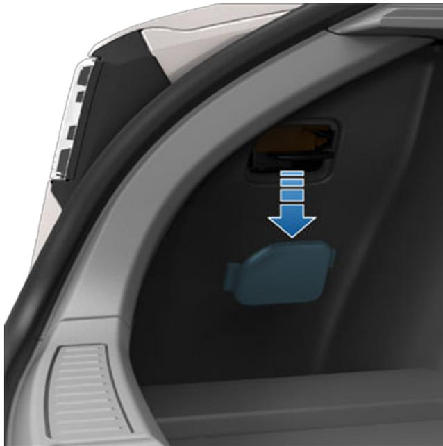
4. 朝车辆前方按住充电接口的手动释放杆（图中红色标示），以解锁充电电缆。
