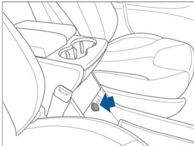
低压电源插座适合连续电流不能超过 11A（峰值 15A）或连续功率不能超过 150W（峰值 180W）的附件。
