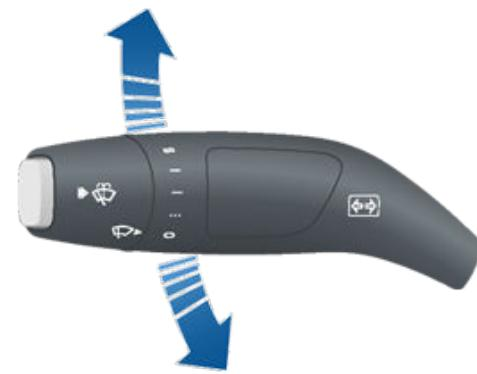
如果方向盘取消转向信号灯或驾驶员将操纵杆回位至中央位置，则转向信号灯将停止工作。
