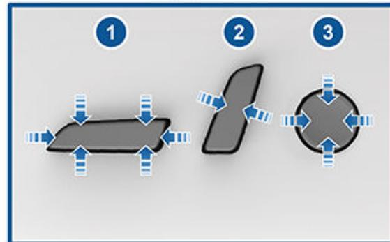
1. 向前/向后移动座椅，并向上/向下调节座椅高度和倾斜角度。
