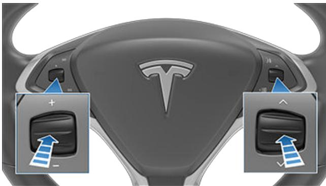
3. 几秒钟后，Tesla 徽标出现。等待大约 30 秒，让触摸屏重新启动完成。几分钟后，如果触摸屏仍无反应或出现异常行为，请尝试循环通断车辆（如果可能）。请参阅[循环通断车辆](#)页码 53。
