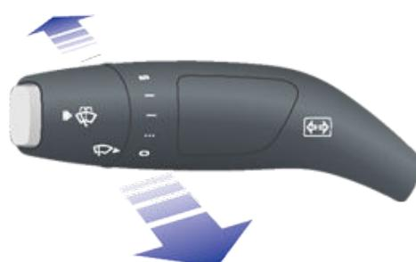
当检测到 Model S 前方有光线时（例如，对面来车），远光灯会自动切换到近光灯。要开启或关闭此功能，请点击**控制 > 自动远光灯**或**控制 > 车灯 > 自动远光灯**。
