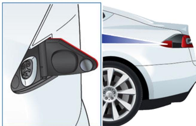
**注：**当您打开充电接口盖板时，充电接口指示灯会呈白色亮起。如果充电接口盖板打开后几分钟内未将充电电缆插入充电接口，充电接口盖板将会关闭。如果发生这种情况，请再次使用触摸屏打开充电接口盖板。
