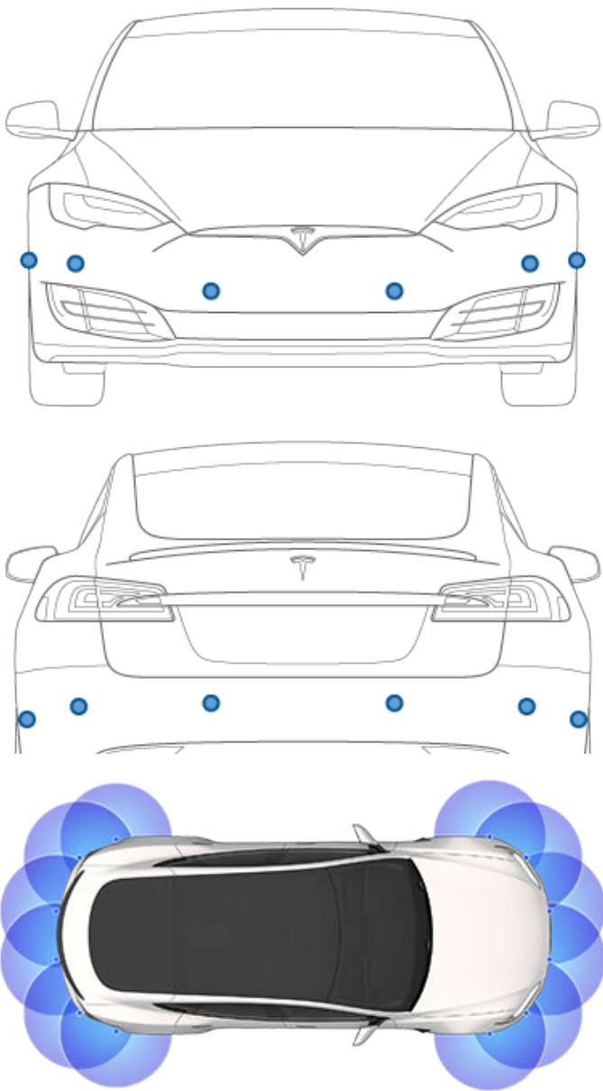
**⚠ 警告：**不要完全依赖驻车辅助系统来判断正在接近的区域是否有物体和/或行人。一些外部因素可导致驻车辅助系统性能降低，没有读取或读取错误（请参阅[限制和虚假警报页码 66](#)）。因此，仅依靠驻车辅助系统来确定 Model S 是否正在接近障碍物，可能会对车辆和/或物体造成损坏，并导致严重伤害。请务必通过目视观察这些区域。倒车时，转头向后看并使用所有的后视镜。驻车辅助系统无法检测到儿童、行人、骑自行车者、动物或移动的物体、突出物、远高于或低于摄像头的物体，或距离摄像头太近或太远的物体。驻车辅助系统仅供参考，不可取代直接目视检查。请务必小心驾驶。
