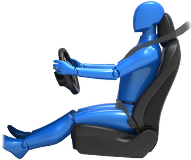
调节座椅位置，以便在尽可能远离前气囊的同时正确地佩戴座椅安全带：
