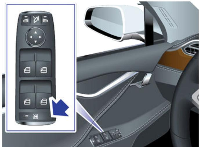
**!** **警告：**有儿童坐在后排座椅时，为确保安全，建议锁定后车窗开关。
