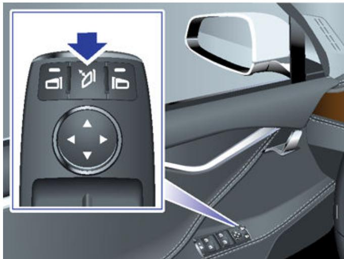
手动折叠后视镜后，后视镜会一直保持折叠状态，直到行驶速度达到 31 mph (50 km/h)（或您手动将其展开）。
