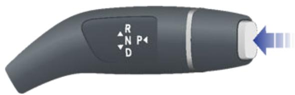
Model S 自动换入驻车挡，可防止在低速行驶时发生侧翻。无论何时连接充电电缆、解开安全带或在前进挡或空挡打开车门，都会发生这种情况。换出驻车挡前，确保充电电缆已拆下，系好安全带，并关上车门。
