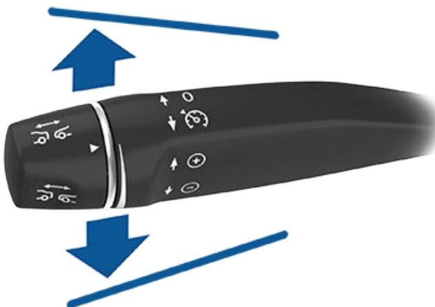
**注：**主动巡航控制取消时，Model S 不会滑行。相反，能量回收制动会使 Model S 减速，减速方式与无主动巡航控制时把脚从加速踏板上移开来降低车速相同（请参阅[能量回收制动 页码 62](#)）。
