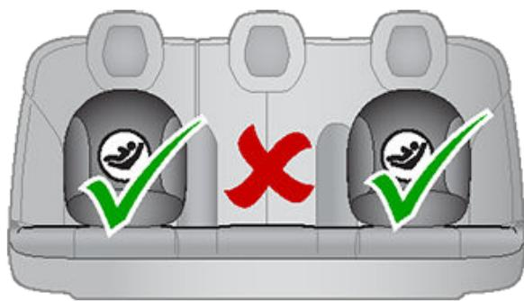
安装 LATCH 儿童安全座椅时，应仔细阅读并遵循儿童约束系统生产商提供的说明书。这些说明介绍了如何将儿童约束系统滑到座椅锚筋上，滑到位时会听到咔嗒声。可能需要抵着座椅靠背用力推儿童约束系统，确保系统紧贴。
