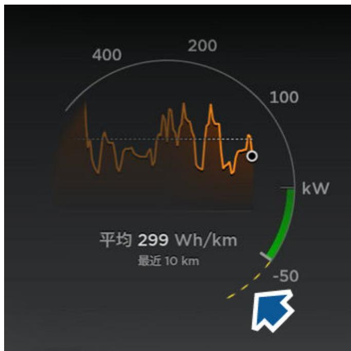
**注：**如果能量回收制动大幅降低 Model S 的行驶速度（比如在高速行驶时，驾驶员的脚完全离开加速踏板），制动灯便会亮起，以便警示周围车辆注意车速变化。
