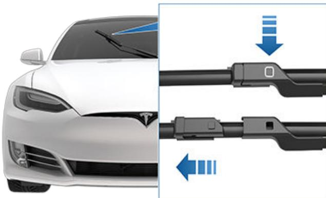
6. 调整雨刮器臂上的新雨刮器片，将其滑向雨刮器臂末端，直至锁定到位。
