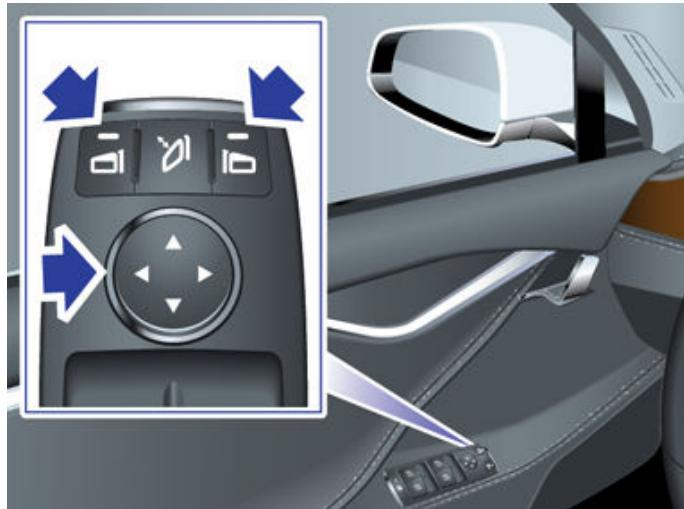
倒车时，自动倾斜功能会自动向下倾斜后视镜。要开启或关闭自动倾斜功能，请点击**控制 > 车辆 > 后视镜自动倾斜**。要调节自动倾斜位置，请在 Model S 换入倒挡的情况下进行后视镜调节。当您换出倒挡时，倾斜的后视镜会恢复至正常（向上）位置。但目前您已将其调整为倒车设置，因此，只要您换入倒车挡，它们就会自动倾斜到所选的向下位置。
