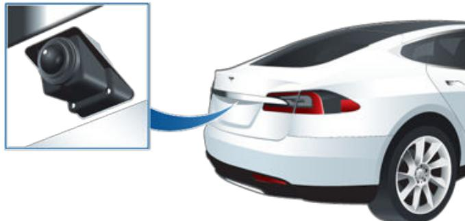
无论何时换入倒挡，触摸屏都会显示来自摄像头的图像。指示线会根据方向盘的位置显示您的行驶路线。当移动方向盘时，这些指示线会进行调整。
