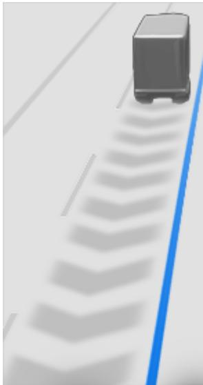
如果您的车速明显高于相邻车道的车辆，Model S 会自动降低行驶速度。该功能尤其适用于拥堵路段，或车辆需要不断变换车道的情况。如果 Model S 探测到其他车辆的行驶速度明显较慢，仪表板将用箭头标示临近车道，并以灰色突出显示探测到的车辆，Model S 将适当减慢行驶速度。要暂时忽略此功能，请踩下加速踏板。
